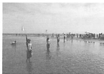
図 1 等間隔で砂を採取している様子
